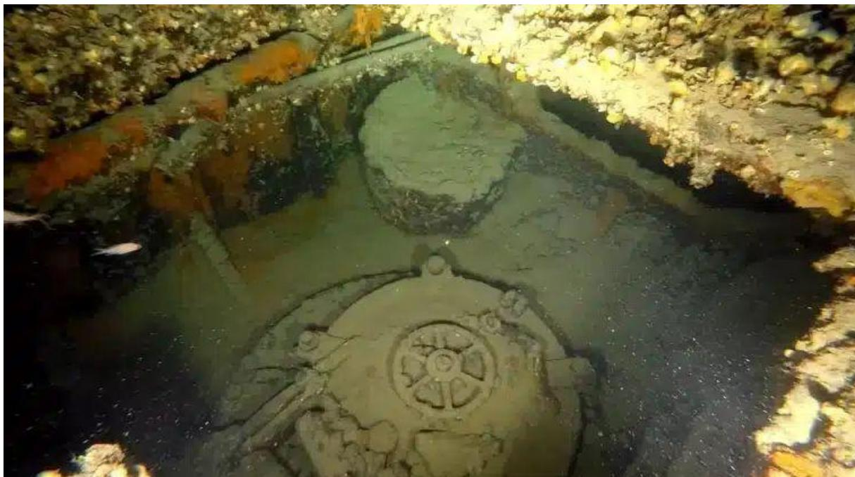
Les écouteilles fermées et le périscope rétracté sur l'épave indiquent que le sous-marin plongeait lorsqu'il a coulé. Crédits : K. Thoctarides/PlanetBlue.gr
